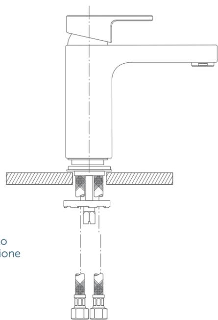
Easy Fix velocizza l'installazione. Un solo bullone, con guarnizione e placca di fissaggio anti-scorrimento in metallo, centra automaticamente il miscelatore.
