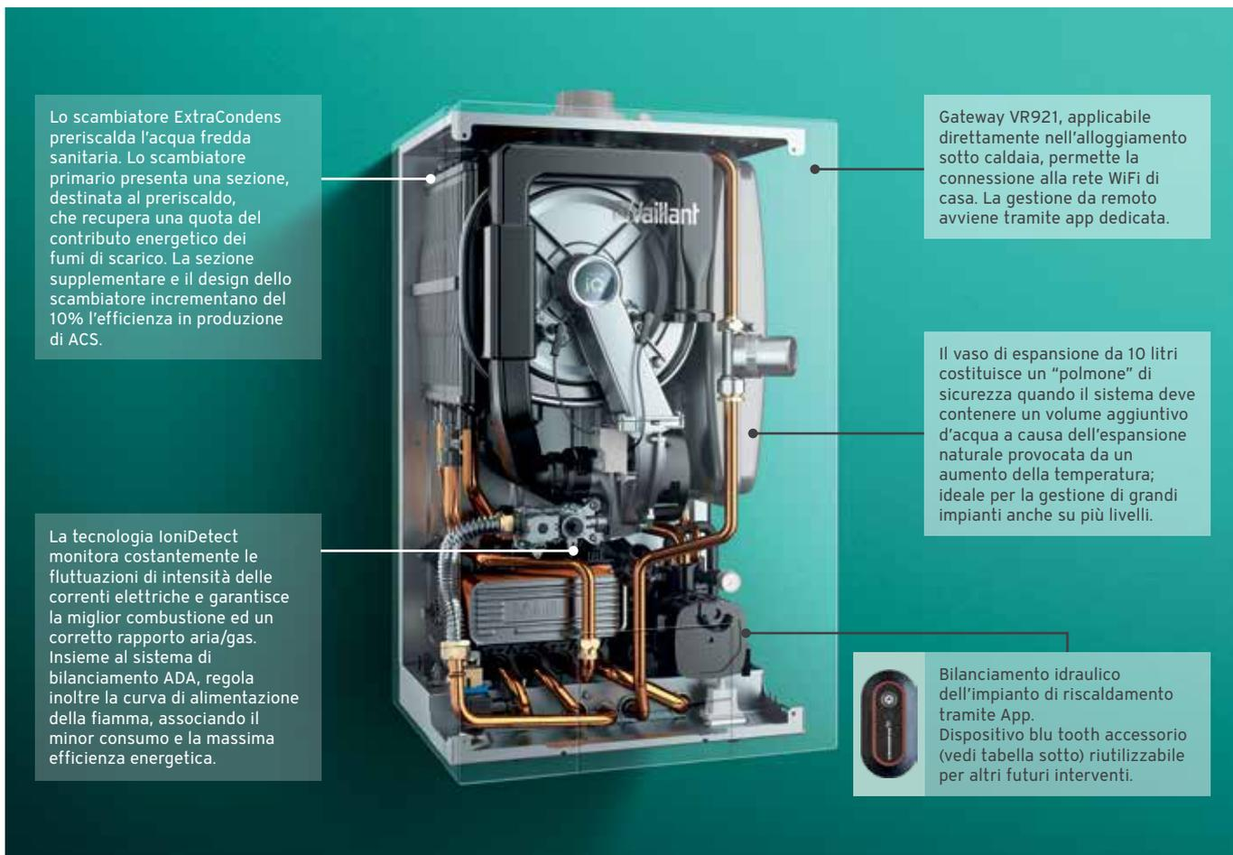
Lo scambiatore ExtraCondens preriscalda l'acqua fredda sanitaria. Lo scambiatore primario presenta una sezione, destinata al preriscaldamento, che recupera una quota del contributo energetico dei fumi di scarico. La sezione supplementare e il design dello scambiatore incrementano del 10% l'efficienza in produzione di ACS.
