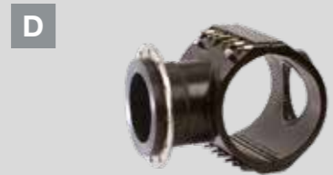
D Collari a tronchetto grandi diametri (LDBS) Semplici, sicuri e con un giusto rapporto qualità/prezzo per condotte acqua e gas in pressione Diametri 250 - 630mm con stacchi/derivazioni DN 150, 200 e 250 PN16
