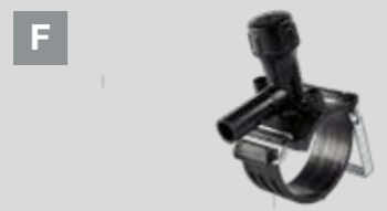
F Collari in carico Semplici, sicuri e con una massima facilità d'installazione A staffa rigida Diametri disponibili 40 - 355mm Stacchi/derivazioni a 20, 25, 32, 40, 50 e 63mm
